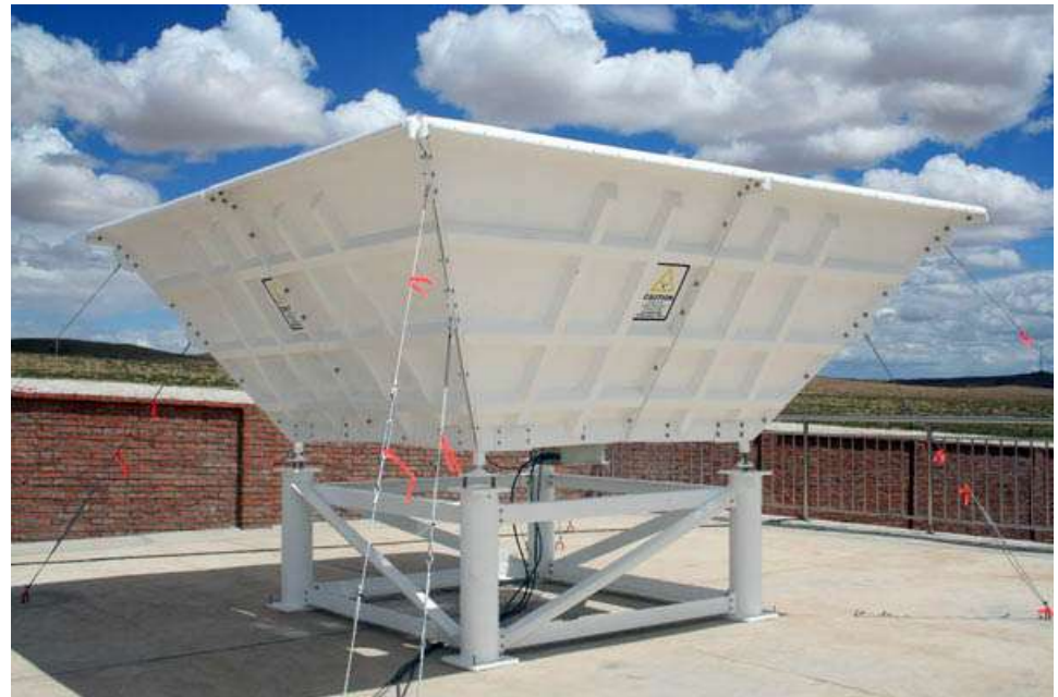
900 MHz wind profiler radar. Courtesy: Vaisala Corp.
