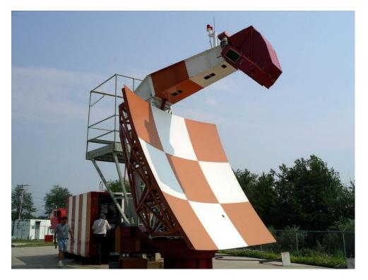
Figure 54. X-band PAR radar.
