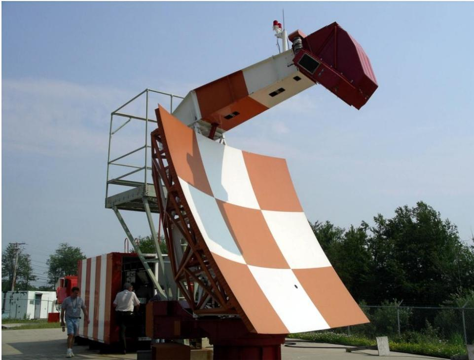
Figure 54. X-band PAR radar.
